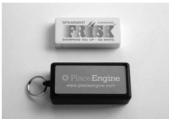
図2：LifeTag: WiFi位置認識技術による継続的位置履歴記録デバイス
