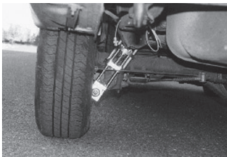
図2 電磁式アクチュエータを搭載した自動車
