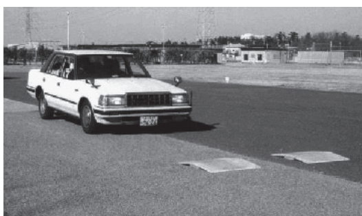
図3 サスペンションによる発電実験
