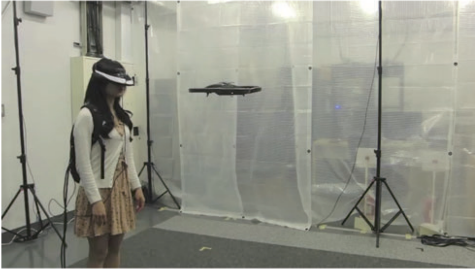
Fig. 5: ドローンと人間を結合する：FlyingHead はドローンが搭載するカメラの映像をヘッドマウンテッドディスプレイに投影し、利用者の頭の動きに追従してドローンが動く。 25)
