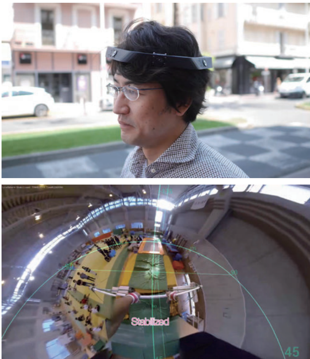
Fig. 6: JackIn Head: 頭部装着型全周囲画像取得による人間—人間接続 27), 37)
