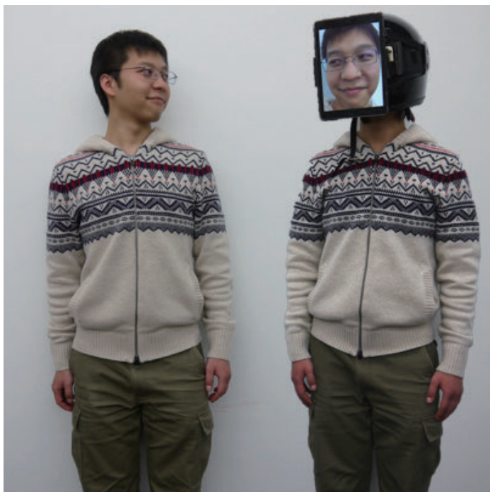
Fig. 9: 他人に体を提供する ChameleonMask: ボディー（右）が頭部に付けたタブレット端末にゴースト（左）の顔を表示して，あたかもゴーストがその場に現れたかのように見せることができる。 36)
