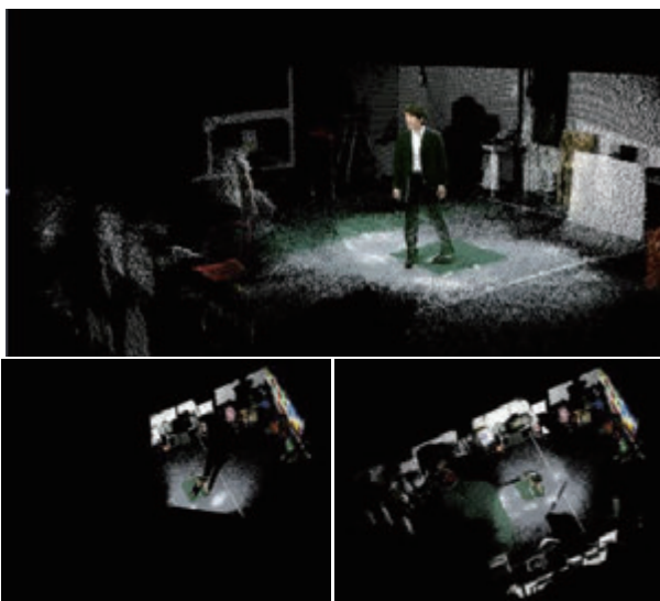
Fig. 8: 三人称視点映像をポイントクラウドで表現：ゴーストがジャックアウトした状態で見る自由視点（三人称視点）映像は，距離画像とRGB画像を同時取得して得られるポイントクラウド（点の集合）として描画される。 30)
