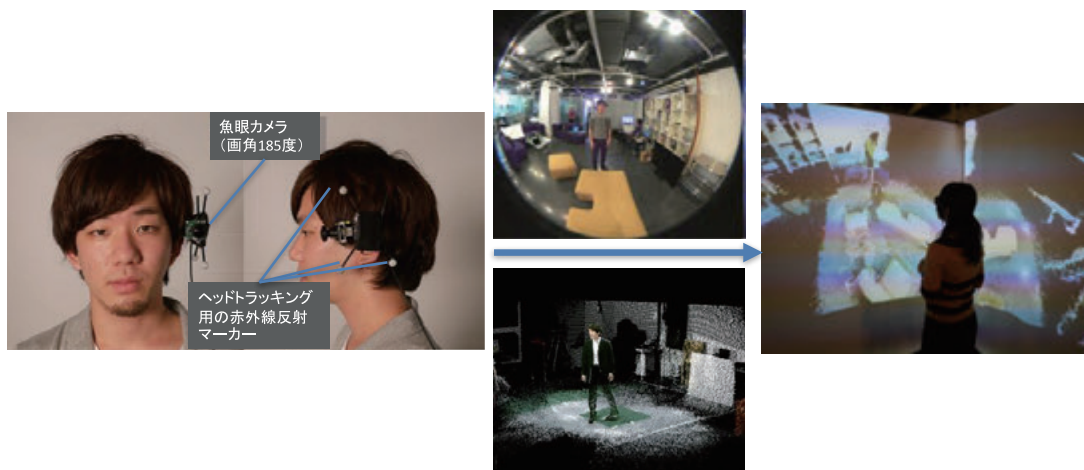
Fig. 7: ボディの視覚をゴーストに伝達：ボディは魚眼カメラと赤外線反射マーカーが付いたヘッドセットを装着する。ボディからの一人称視点画像・距離センシングによって構築された3人称視点（自由視点）映像は、ゴーストを取り囲むように配置された3面の大画面（右）に映し出される。 30)
