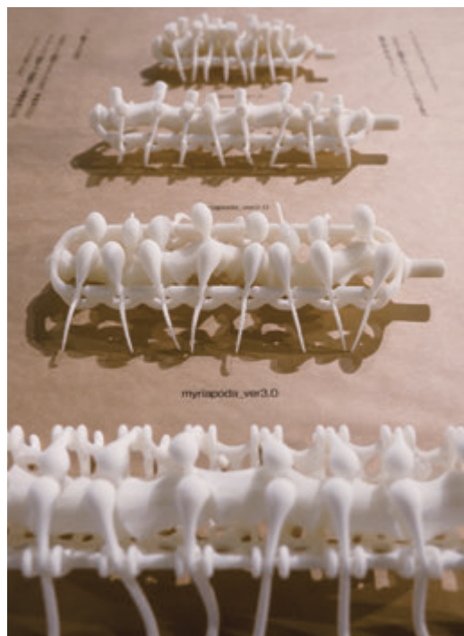
上：パラリンピックアスリート高桑早生選手のためにデザインされた義足 下：ADDITIVE MANUFACTURING (3Dプリンタ)により、全ての構造が一体で造形されたロボットREADY TO CRAWL
